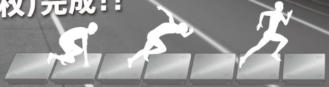
フォースプレートで走力を計測する場合、これまで競技者がプレートの位置を気に掛ける必要がありました。50m走行路に設置した50枚のフォースプレートをCPU処理で1台として計測することにより、いつもの走行計測を可能にしました。これにより、現実的で詳細なデータを取得できます。
