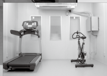
高精度の温・湿度制御 スポーツ医科学用低酸素試験室
